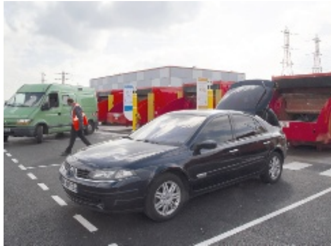
→ Fini le déchargement depuis un quai haut perché : les bennes sont désormais à hauteur de véhicule.
